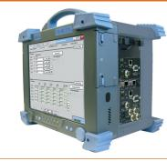
Los módulos FTB-81X0 se alojan en el nuevo receptáculo de ocho ranuras (GP-408) de la plataforma portátil FTB-400. Esta configuración admite varios módulos FTB-81X0, ofreciendo capacidades simultáneas de realización de pruebas en varios puertos.
