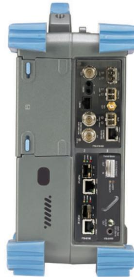
Le Module de test Ethernet Packet Blazer FTB-8510B peut être contenu dans le Système universel de test FTB-400, la plateforme intégrée, robuste et portable d'EXFO. Le Module de test Ethernet à 10 gigabits Packet Blazer FTB-8510G et le Module de test SONET/SDH nouvelle génération FTB-8130 sont aussi illustrés dans la plateforme.
