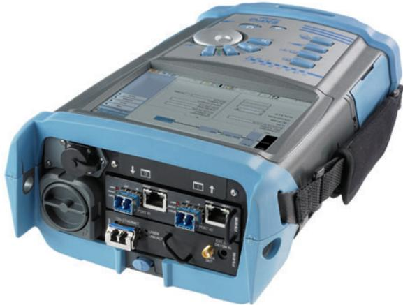
Le Module de test Ethernet Packet Blazer FTB-8510B peut être contenu dans la Plateforme compacte FTB-200. Le Module de test Ethernet à 10 gigabits Packet Blazer FTB-8510G est aussi illustré dans la plateforme.
