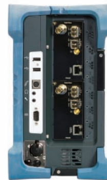
Los módulos FTB-8525/8535 Packet Blazer también son compatibles con la plataforma FTB-500. Aquí, se muestran dos módulos en la FTB-500, que abordan aplicaciones multicanal.
