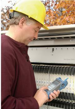
Die Lichtquelle ELS-500 von EXFO bietet eine herausragende Stabilität und hohe Messgenauigkeit mit zwei Wellenlängen (1310/1550 nm) an einem Ausgang oder vier Wellenlängen (850/1300 nm und 1310/1550 nm) an zwei Ausgängen. Mit ihrer automatischen Wellenlängenumschaltung ist sie die perfekte Ergänzung zum Leistungspegelmesser EPM-500 für die schnelle und komfortable Messung der Dämpfung auf Glasfaserstrecken.
