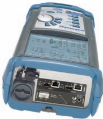
El módulo de pruebas de Ethernet de 10 gigabits FTB-8510G Packet Blazer puede alojarse en la plataforma compacta FTB-200. También se muestra en la plataforma el módulo de pruebas de Ethernet FTB-8510B.
