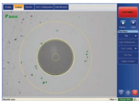
仍符合验收标准的有缺陷连接器
