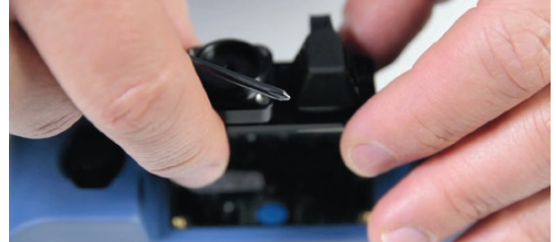
Les pièces du wattmètre et du localisateur visuel de défauts sont faciles à installer : il suffit de les fixer à l'écran MAX-FIP à l'aide de quatre vis.
