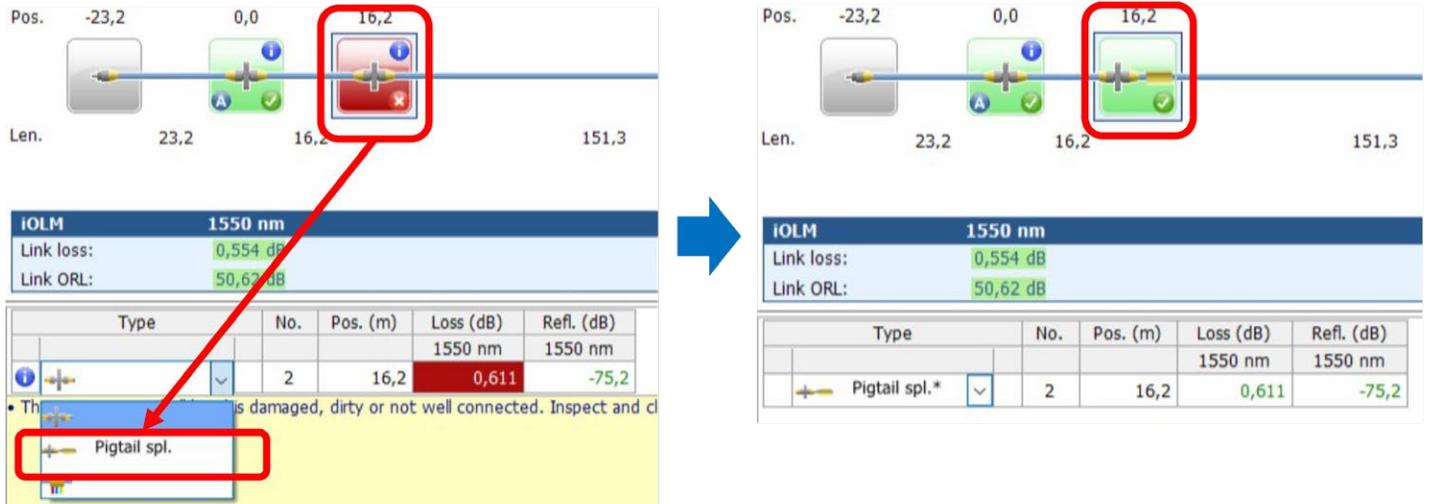
通常コネクター (上の例では0.5 dbでのしきい値) からカスタム「ピッグテイルスプライスコネクター」にイベントを変更すると、カスタムアイコンが表示され、疑似障害を回避できるように、ユニットがカスタムしきい値 (上の例では0.75 db) に調整します。変更された要素には、トレースのためにアスタリスク(\*)が付きます。
