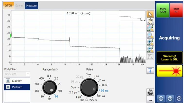
ダイヤルを回してその場でリアルタイム取得パラメータを調整すると、トレースに及ぼす影響が瞬時に表示されるため、効率性を最適化できます。特性評価を始める準備が整ったら、「Start iOLM」ボタンを押すだけです。リアルタイム取得を手動で中断したり、メニューを開いたりする必要はありません。
