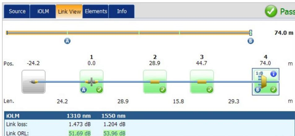
図3. テストパスラストマイル損失およびORLは仕様範囲内です。スプリッターの存在が確認され、予想比率と照合し、フィーダーへの継続性があります。ラストマイル敷設が保証されます。
