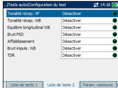
**Note :** Les tests *Tonalité réception (VF)* et *Tonalité réception (WB)* s'excluent mutuellement. Si l'un est activé, l'autre est automatiquement désactivé.
