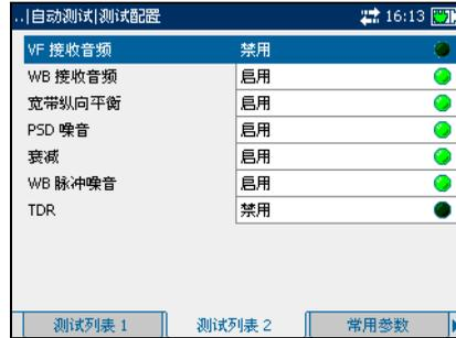
**注意：** *VF 接收音频测试和WB 接收音频测试相互排斥。启用其中一个测试后，会自动禁用另一个。*
