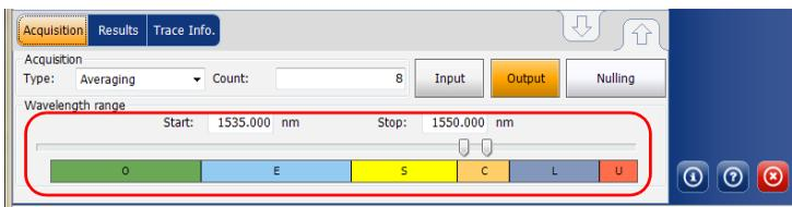
Puede seleccionar el rango de la longitud de onda introduciendo los valores de inicio y detención o seleccionando un rango en el control deslizando doble.
