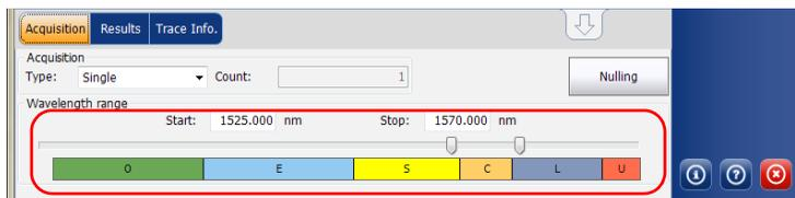
Puede seleccionar el rango de la longitud de onda introduciendo los valores de inicio y detención o seleccionando un rango en el control deslizador doble.
