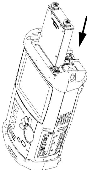
4. 将模块的凸边插入设备模块插槽的凹槽中。
