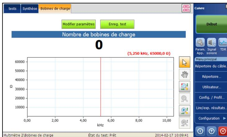
Le groupe et le test actuels mesurés actuellement s'affichent dans la barre d'état, **Signal\Bobines de charge**.
