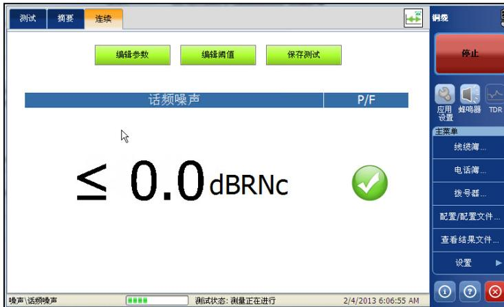
状态栏会显示当前正在执行的测试组和测试，例如，“噪声\音频噪声”。
