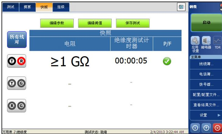
状态栏会显示当前正在执行的测试组和测试，例如，“万用表 2\绝缘度”。
