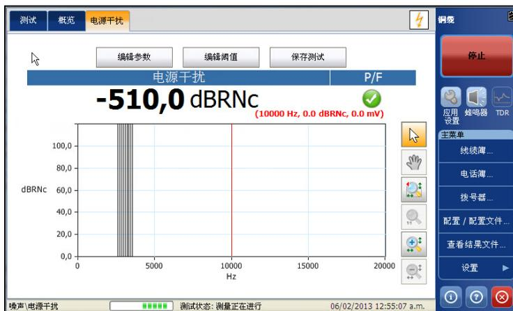
状态栏会显示当前正在执行的测试组和测试，例如，“噪声 \ 电源干扰”。
