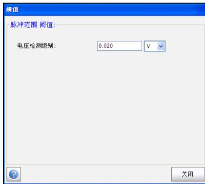
“电压检测电平”可用于设置测试阈值（单位为 V 或 mV）。测试正在运行时可以更改阈值，但更改后的阈值将在下一次触发事件时应用。
