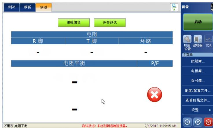
状态栏会显示当前正在执行的测试组和测试，例如，“万用表 \ 电阻平衡”。
