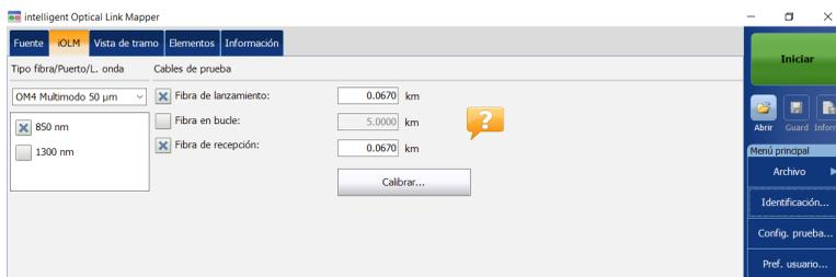
2. Si la opción de software ICERT está activada, seleccione el puerto que va a utilizar para realizar la prueba. En este momento también se selecciona el núcleo de la fibra; para fibras C, seleccione 50 µm y para fibras D, seleccione 62,5 µm.
