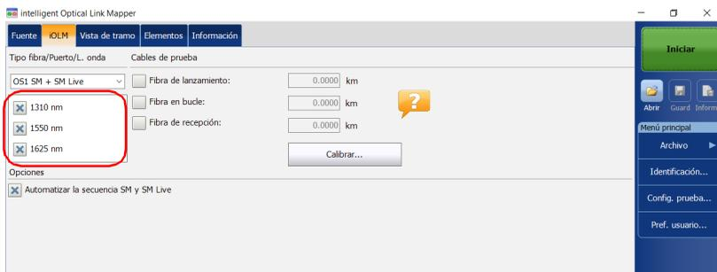
4. Para activar la secuencia de adquisición automática, seleccione la casilla de verificación **Automatizar la secuencia SM y SM Live**.
