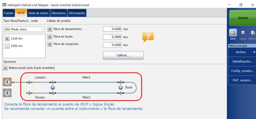
La división automática de la medición inicial solo puede efectuarse si la longitud de las fibras de lanzamiento, bucle y recepción está correctamente especificada en la aplicación. Para obtener más información, consulte *Configuración del iOLM* en la página 42.
