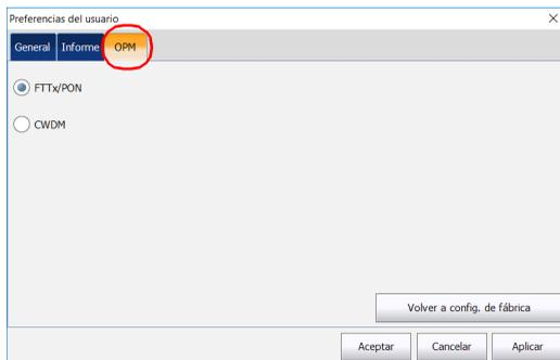
3. Seleccione el modo de medidor de potencia.
