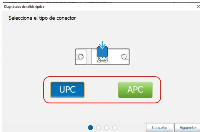
7. Conecte el cable de prueba al puerto óptico de la unidad y después pulse **Siguiente**.
