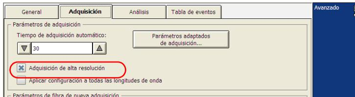
**Nota:** Si el OTDR admite longitudes de onda monomodo, monomodo activo o multimodo, la función de alta resolución se activará para las longitudes de onda monomodo, monomodo activo o multimodo según el tipo de fibra seleccionada.
