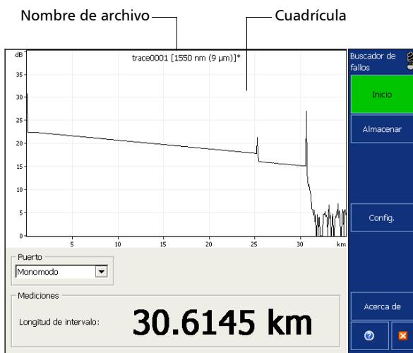
**Nota:** La configuración de la pantalla de trazas usada en el modo Buscador de fallos es independiente de la que se emplea en los otros modos de OTDR (Auto y Avanzado).
