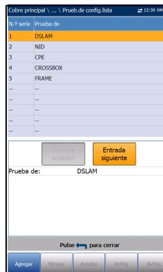
4. Para editar una entrada, pulse las teclas de flecha arriba/abajo para resaltar la prueba seleccionada. Pulse la tecla de función **Aceptar** para confirmar los cambios. Si pulsa los botones **Entrada anterior/siguiente** antes de la tecla de función **Aceptar**, perderá el valor modificado.
