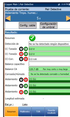
**Nota:** La aplicación de una tensión superior con el tiempo tiende a eliminar la humedad. Algunos fallos aparentemente pueden desaparecer tras un período de humectación, aunque solo desaparece la humedad. El fallo sigue estando presente y es probable que la humedad reaparezca más adelante. Por ello, no amplíe el período de humectación a no ser que esté probando la resistividad del aislamiento (PIC, papel, etc.).
