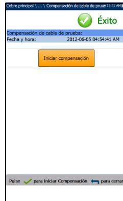
**Nota:** *Efectúe siempre una compensación de cable de prueba si los cables de prueba se extrajeron o sustituyeron recientemente.*
