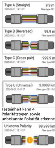
Testeinheit kann 4 Polaritätstypen sowie unbekannte Polarität erkennen.
