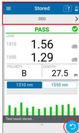
Test ausgeführt, 4 s bis zum nächsten Test. Fahren Sie dann mit der nächsten Messung fort.
