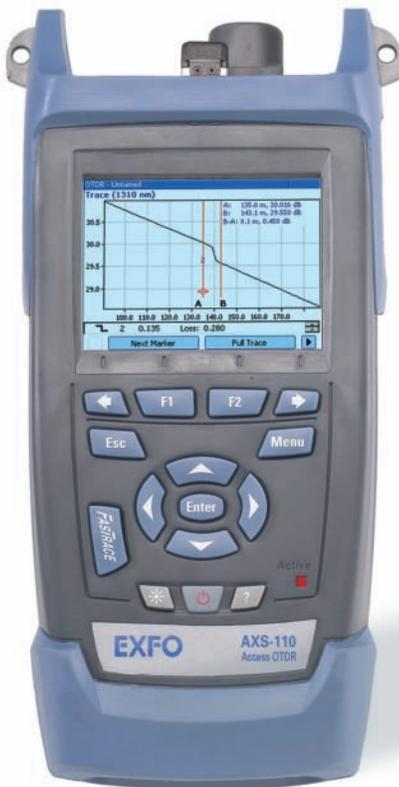
アクセス/FTTH ネットワークとLAN/WAN ネットワークの試験に最適なコンパクト、小型軽量かつ頑丈な OTDR
