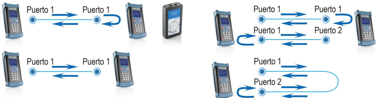
■ Realización de pruebas de puerto único (resultados unidireccionales o de ida y vuelta).
