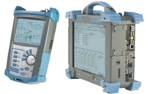
FTB-8120/8130 モジュールは、FTB-200 および FTB-400 の両方のプラットフォームに搭載できます。
