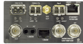
光および電気イーサネット・アドドロップインタフェースを含む次世代 SONET/SDH および OTN のハードウェアを備えた FTB-8130NG。
