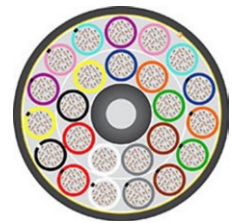
Exemple d'un câble à 3 456 fibres.
