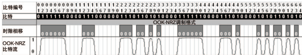
图16—NRZ格式传输示例
