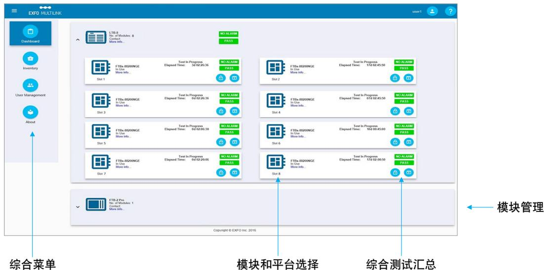
EXFO Multilink使多个用户能够通过EXFO的LTB-8主机服务器连接到任何实验室，不需要外接服务器。可以使用任何PC或平板电脑，通过常见的网络浏览器访问EXFO Multilink的综合仪表盘。
