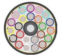
Exemple d'un câble à 3 456 fibres.
