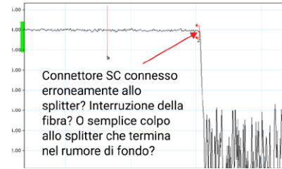
Figura 2. Traccia OTDR dell'ultimo miglio.
