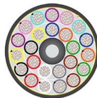
Esempio di cavo a 3456 fibre.
