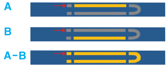
iOLM에서 루프백 테스트 방식과 iLOOP 옵션을 사용하면 피이버 두 개를 한꺼번에 테스트할 수 있습니다. A 링크만, B 링크만 보거나 루프까지 포함해 A-B 링크 전체를 볼 수 있습니다.
