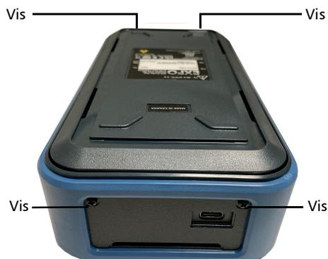
5. Retirez la base du compartiment pour accéder à la batterie. Retournez l'appareil sur la droite vers le haut pour faciliter le dégagement du bas du compartiment.
