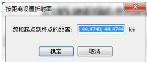
**注意：** 如果从选定的测量获得的距离值不相等，这些值之间以分号分隔。在计算得到新的折射率之后，程序会更新与位置及距离相关的值和 OTDR 图形。
