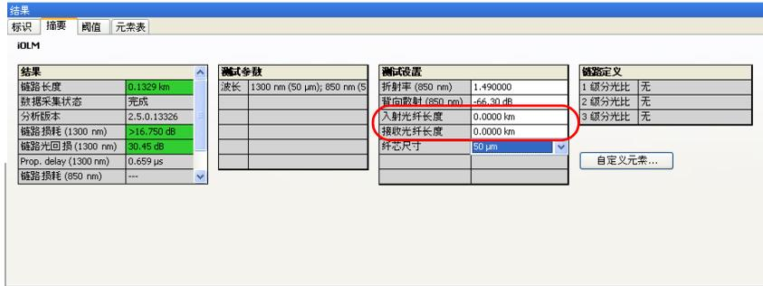
更改入射光纤和接收光纤的长度后，程序会执行局部分析。进行局部分析时，程序会重新计算链路长度、链路损耗、链路光回损、元素位置、元素区段长度和诊断的值。局部分析不会更改链路中已添加或修改的元素。
