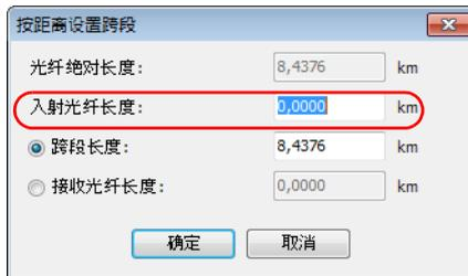
4. 选择要输入跨段长度还是输入接收光纤长度，然后输入相应的值。未选中的值会根据输入的值自动更新。如果跨段终点的新位置上没有事件，则程序会自动创建一个新事件。
