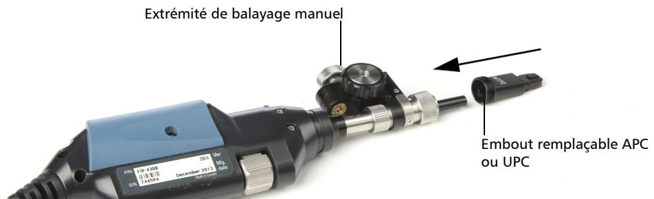
3. Insérez l'adaptateur traversant sur l'embout.
