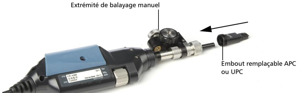
3. Insérez l'adaptateur traversant sur l'embout.
