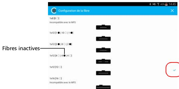
**Note :** *L'application n'analyse pas les fibres inactives même si elles apparaissent en mode vidéo en direct.*
