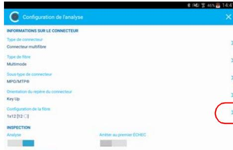
**10b.** Sélectionnez la configuration de la fibre adaptée au connecteur que vous utilisez pour votre inspection.
