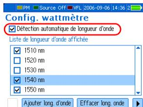
2. Utilisez les flèches pour sélectionner **Détection automatique de longueur d'onde**, puis appuyez sur **Enter**.
