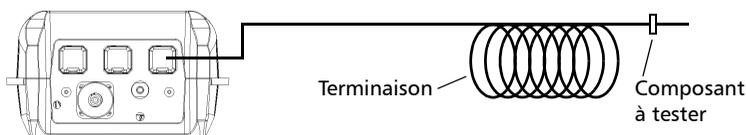
4. Terminez la fibre aussi proche que possible *avant* le composant à tester. Enroulez-la au moins dix fois autour d'un mandrin ou d'un outil de petit diamètre, en ajoutant des tours jusqu'à ce que la lecture se stabilise.
