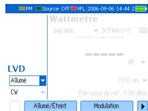
**Note :** L'indicateur **Active** montre toujours l'état du port source, LVD, réflectomètre ou micro-masque (même en mode FIP ou inactif).
