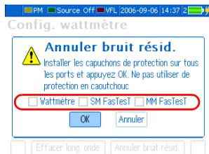
Le processus d'annulation de déviation prend environ 10 secondes. Des coches apparaissent à côté des détecteurs corrigés. Si de la lumière est toujours détectée, vous devrez installer les capuchons de protection convenablement et recommencer.
