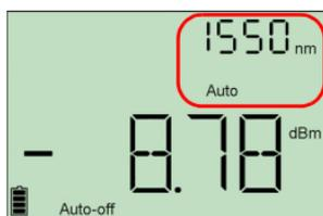
Si la source émet un signal de longueur d'onde automatique ou est en mode (voir *Détection automatique des longueurs d'onde* à la page 16 et ), le wattmètre s'aligne automatiquement sur la longueur d'onde de la source. OU
