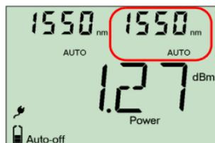
Votre wattmètre s'aligne automatiquement sur la longueur d'onde de la source. Si les longueurs d'onde sont différentes, il émet un bip et retourne en mode normal.
