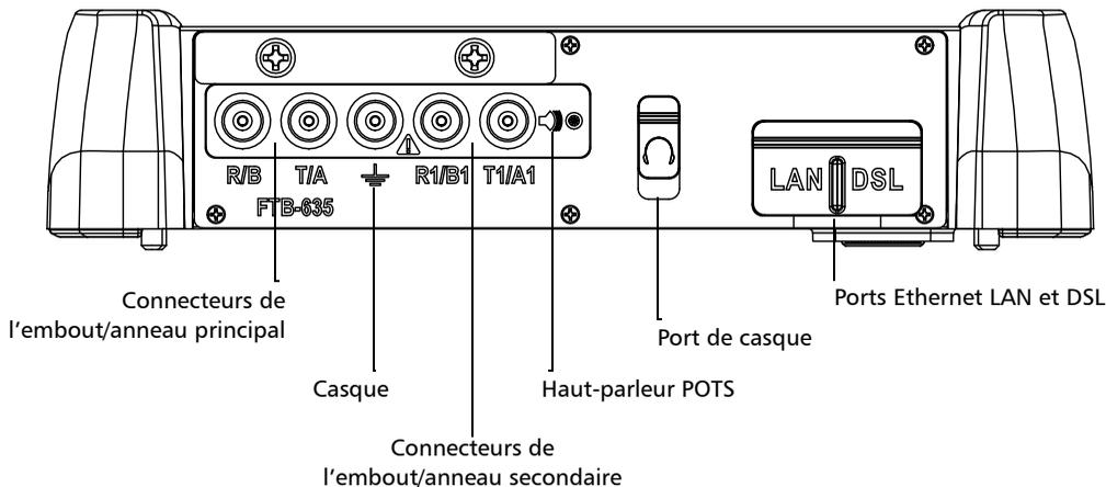
**Note :** Lorsque vous connectez un câble réseau au port LAN, utilisez l'extrémité de la prise RJ-45 du câble fourni avec l'appareil. Les ports de télécommunication présentent une tension transitoire maximale de 1500 V. Les circuits de télécommunication externes nécessitent une isolation de base.
