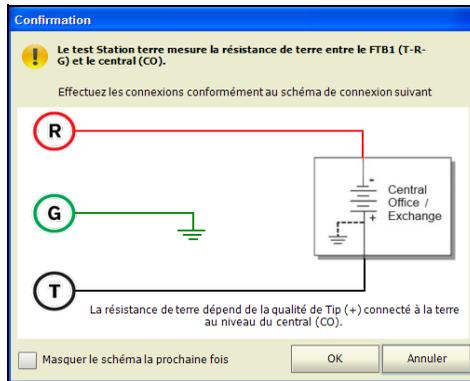
**Note :** Le test **Station terre** fonctionne uniquement avec des bureaux centraux où l'embout (A) est connecté à la terre.
