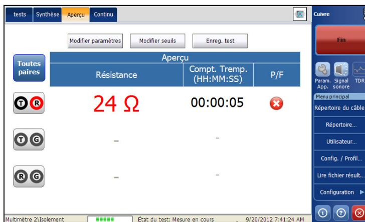
Le groupe et le test actuels mesurés actuellement s'affichent dans la barre d'état, **Multimètre 2 \ Isolement**.
