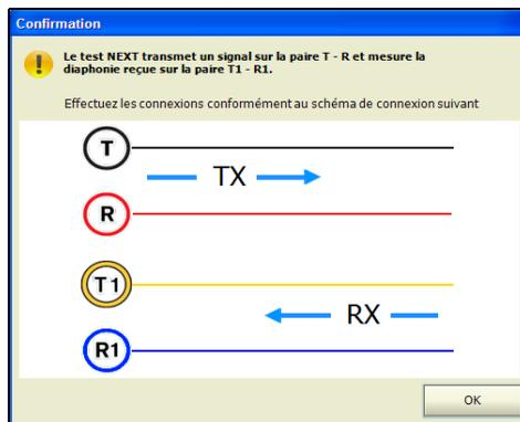
Cependant, vous pouvez afficher le schéma de connexion à tout moment en cliquant sur **Schéma de connexion** in dans la fenêtre **Continu** ou **Spectre**. Dans ce cas, le test ne commence pas quand vous appuyez sur le bouton **Ok** pour fermer la fenêtre **Confirmation**.
