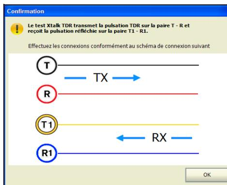
Vous pouvez toutefois vérifier le schéma de connexion à tout moment en appuyant sur le bouton **Schéma de connexion** dans la fenêtre principale **Xtalk TDR**. Dans ce cas, le test ne commence pas quand vous appuyez sur le bouton **Ok** pour fermer la fenêtre **Confirmation**.
