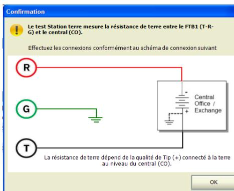
Vous pouvez toutefois vérifier le schéma de connexion à tout moment en appuyant sur le bouton **Schéma de connexion** dans la fenêtre principale **Station terre**. Dans ce cas, le test ne commence pas quand vous appuyez sur le bouton **Ok** pour fermer la fenêtre **Confirmation**.
