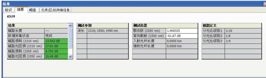
群系数和背向散射值显示在“测试设置”表格下。
