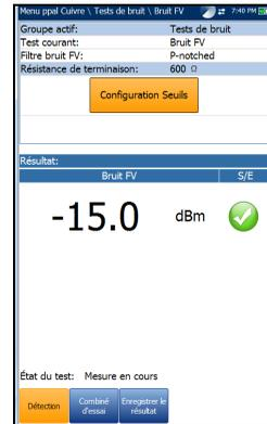
**Note :** *La combinaison du filtre de bruit FV sélectionné et des unités de niveau actuelles sélectionnées dans Configuration/Paramètres d'application a une incidence sur les unités de mesure affichées sur cette page.*
