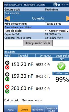
**Note :** La précision de la **Mesure de la capacité Terminal 2** est affectée par l'utilisation de FED, et il est recommandé d'utiliser la méthode **Terminal 3** (méthode par défaut).
