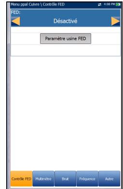
Lorsque **FED** est **Auto** ou **Manuel** et que vous démarrez un test, le MaxTester vous avertit si le niveau de la batterie de FED est faible. Sélectionnez **OK** pour fermer le message et exécuter le test. De plus, si le FED est absent ou ne répond pas, une boîte de dialogue de **Confirmation** s'affiche et vous demande si vous souhaitez désactiver FED et exécuter le test malgré tout.
