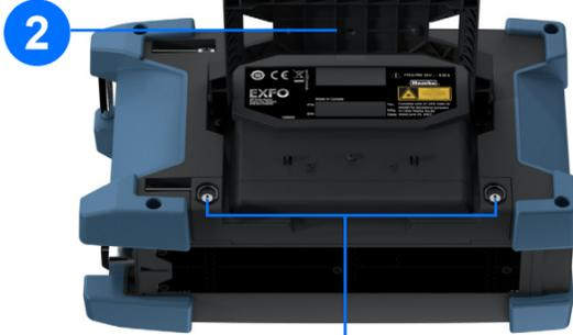
**3** Schrauben gegen den Uhrzeigersinn drehen, bis sich die Klappe des Akkufaches löst.
