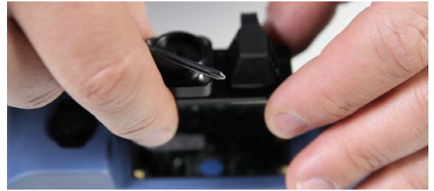
功率计和VFL选项易于安装在MAX-FIP的显示屏上面，只需使用四个螺丝。
