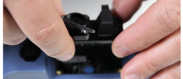
Die mühelos zu installierenden Optionen (Leistungspegelmesser/VFL-Rotlichtquelle) werden mit vier Schrauben am MAX-FIP Display befestigt.
