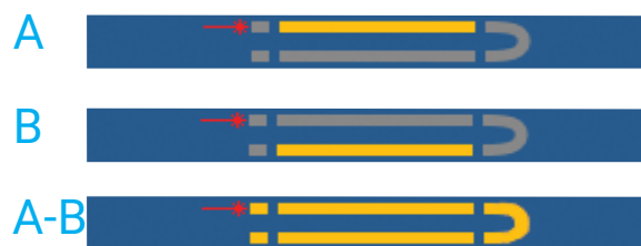
使用iOLM (光眼) 上的环回测试方法和iLOOP选项，可同时测试两条光纤。只查看链路A、链路B或包括环路的整个A-B链路。
