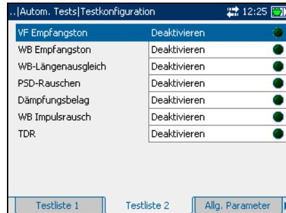
**Hinweis:** Die Tests *VF-Empfangston* und *WB-Empfangston* schließen sich gegenseitig aus. Wenn ein Test aktiviert wird, wird der andere automatisch deaktiviert.
