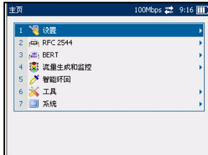
“设置”：可以配置测试接口、模块、远端选择、保存或加载完整的设备配置。
