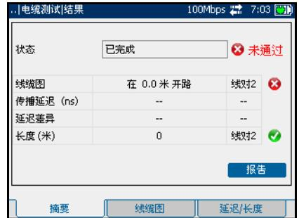
“长度 (m/ft)”：表示电缆长度值最差的线对长度。启用时还显示通过 / 未通过判定。有关详细信息，请参阅第 159 页“电缆测试结果 - 延迟 / 长度”。
