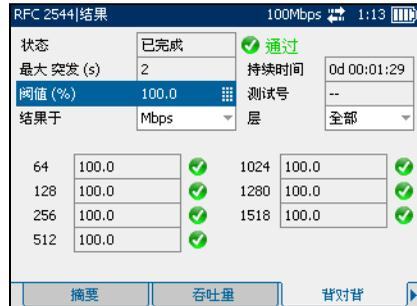
注意：第 48 页“全局配置”中“双测试仪”参数设为“禁用”时才显示“最长突发”。
