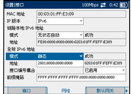
“地址”：只有“模式”为“静态”时才能配置此字段。“链路本地 IPv6 地址”必须以“FE80”开头。接受的范围从“FE80:0000:0000:0000:0000:0000:0000”至“FE80:0000:0000:0000:FFFF:FFFF:FFFF:FFFF”。默认地址为“FE80::[Interface ID]”，其中“[Interface ID]”是根据源 MAC 地址生成的。选择“地址”字段进行编辑时，“最新 IP”按钮出现在屏幕底部。按相应功能键显示之前配置的 IP 地址列表。如有可能，从列表中选择所需的 IP 地址。
