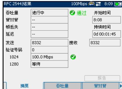
注意：第 48 页“全局配置”中“双测试仪”参数设为“远端”时，只显示远端模块的“启动时间”和“持续时间”。
