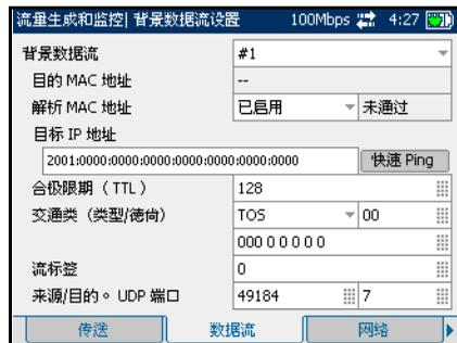
对于 IPv4，启用时向网络发送 ARP 请求获取选定 IP 地址对应的 MAC 地址。
