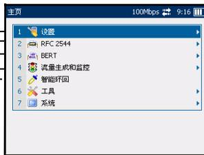
“智能环回”：可以交换 MAC、IP、UDP/TCP 层的源地址和目的地址后将数据流发送回来。
