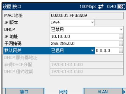
3. 配置“IP 地址”。默认 IP 地址为“10.10.0.0”。选择“IP 地址”字段进行编辑时，“最新 IP”按钮出现在屏幕底部。按相应功能键显示之前配置的 IP 地址列表。如有可能，从列表中选择所需的 IP 地址。
