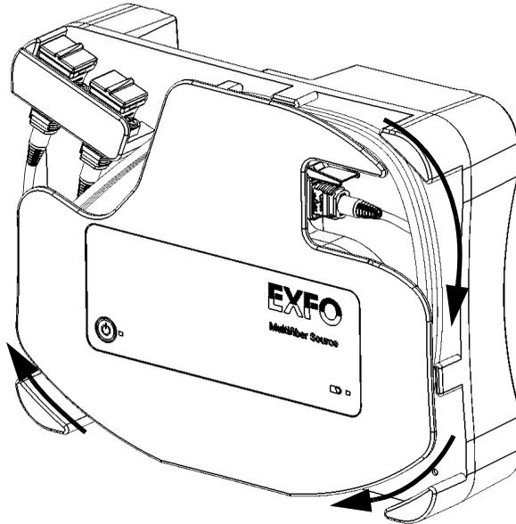
3. 如果您使用的光纤跳线带有单个 MPO-12 或 MPO-24 连接器，可以将该连接器连接到两个适配器中的任意一个。使用 MPO-24 分芯（Y 型）光纤跳线时，必须将光纤跳线的两端分别连接到一个适配器。
