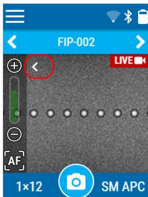
**注意：** 在多光纤模式下，您可以对正在查看的一侧（左侧或右侧）进行手动调焦。在设置菜单中启用了自动对焦功能后，如果您用手指在屏幕上向左或向右滑动，设备会自动优化新图像。
