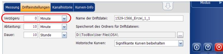
3. Wählen Sie eine Abtasteinheit und geben Sie eine Abtastzahl ein, um die Zeit zwischen dem Beginn jeder Erfassung bei einer Driftmessung festzulegen.
