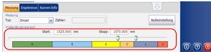
Sie können den Wellenlängenbereich auswählen, indem Sie einen Start- und einen Stoppwert eingeben, oder indem Sie auf der Skala einen Bereich auswählen.
