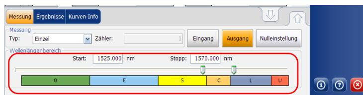
Sie können den Wellenlängenbereich auswählen, indem Sie einen Start- und einen Stoppwert eingeben, oder indem Sie auf der Skala einen Bereich auswählen.
