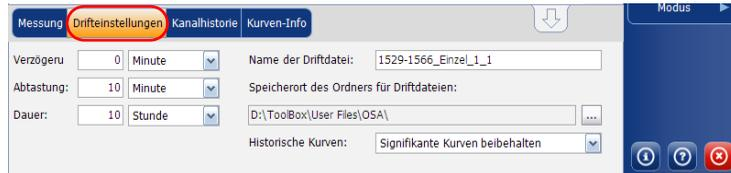
2. Legen Sie eine Verzögerungseinheit und eine Anzahl fest, bevor Sie die erste Erfassung im Rahmen einer Driftmessung durchführen. Die Anwendung wartet diese Zeit, bevor die erste Erfassung im Rahmen der Driftmessung beginnt.
