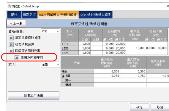
**注意：** 选择了该选项后，窗口右侧的“最大损耗”列会分成两列，分别显示单向损耗值和双向损耗值。这样，您可以为两种测试设置不同的值。
