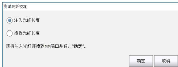
6. 如果要手动指定注入光纤和接收光纤的长度，请在相应的框中输入值。
