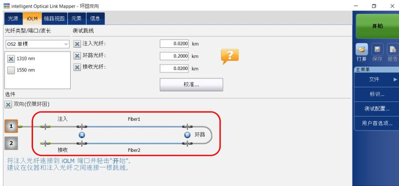
只有在应用程序中为注入光纤、环路光纤和接收光纤指定适当的长度，应用程序才能自动分离初始测量结果。有关详细信息，请参阅第 40 页“配置 iOLM”。
