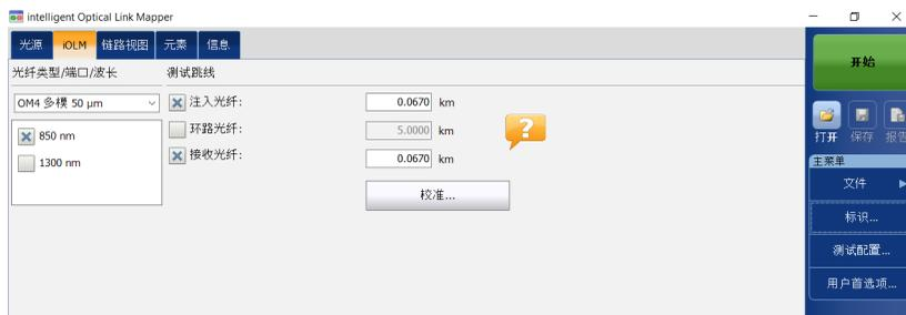
2. 如果已激活 ICERT 软件选项，请选择测试要使用的端口。同时选择纤芯：对于 C 型光纤，选择 50 μm 的纤芯；对于 D 型光纤，选择 62.5 μm 的纤芯。
