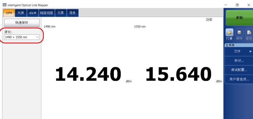
**注意：** 如果在“波长”下拉框中选择两个波长，则应用程序会测量两个功率电平。
