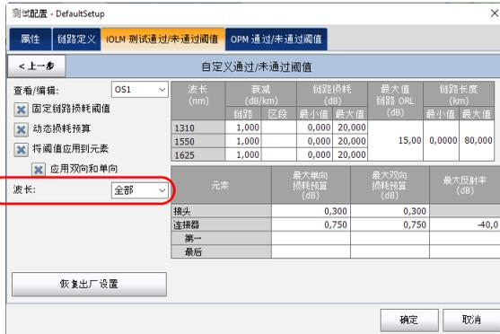
10. 轻击“上一步”退回上一级菜单，然后设置其他配置参数。轻击“确定”确认更改并关闭窗口。轻击“取消”忽略更改并关闭窗口。
