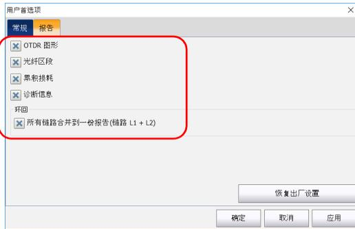
**注意：** 在以下情况下，应用程序无法生成 OTDR 图形：**iOLM 测量结果缺少所需的 OTDR 中间数据； iOLM 数据采集过程被手动中断； 由于检测到在线光纤而导致数据采集过程自动中断。**
