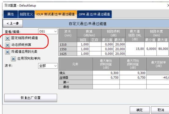
如果在链路定义中指定了光纤类型（有关详细信息，请参阅第 94 页“定义测试链路”），则只能编辑该光纤类型的阈值。如果选择的光纤类型是“未指定”，您可以为各种可用的光纤类型指定阈值。
