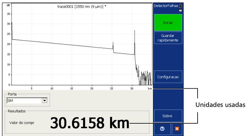
**Nota:** As unidades de distância usadas no modo Localizador de erro são independentes daquelas usadas em outros modos do OTDR (Automático e Avançado).
