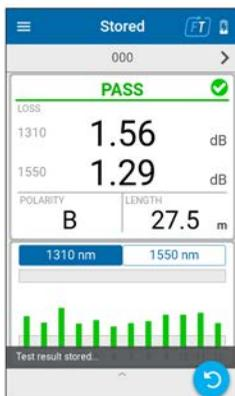
Prueba ejecutada, 4 s para volver a realizar la prueba. A continuación, vaya a la siguiente medición.
