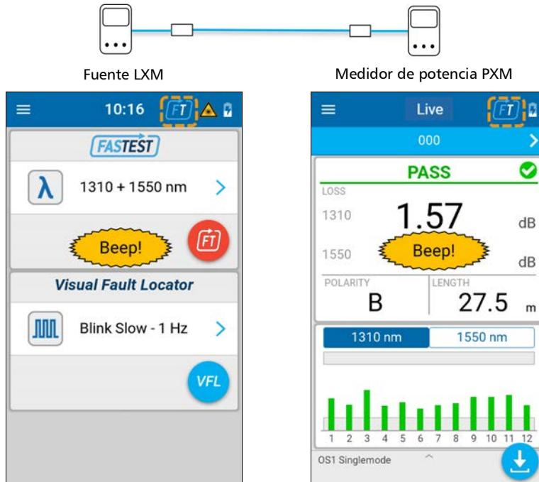
Esta característica le permite detectar automáticamente si la fuente LXM y el medidor de potencia PXM están conectados en el mismo cable. Active FasTesT en LXM y, cuando se detecte el PXM en la misma fibra, se emitirá una notificación sonora en ambas unidades.
