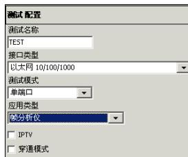
1e. 选中“穿通模式”复选框使用两个 RTU-310 测试端口以非干扰方式启用两个端点间的以太网双向在线流量监测。不支持数据流、告警和误码生成以及 Ping 和路由跟踪功能。吞吐量模式是仅 RTU-310 上可用的软件选件且需要启用后才可用（请参阅第 289 页“软件选件”）。穿通模式只对“双端口”拓扑可用默认不选中“穿通模式”复选框。
