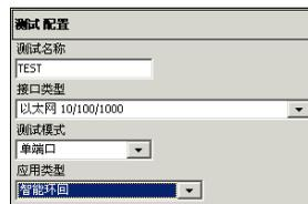
对于 RTU-310“双端口”，选择第一个端口然后继续进行第一个端口的其他配置。但是，在单击“完成”前，请单击“上一步”数次返回端口设置窗口，选择第二个端口并完成该端口的其余配置。
