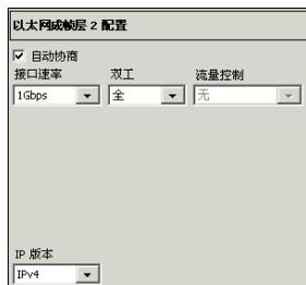
4b. 设置“IP 版本” (IPv4 或 IPv6)。“IP 版本”只有启用 IPv6 软件选件 (SK-IPV6) 时才可用。
